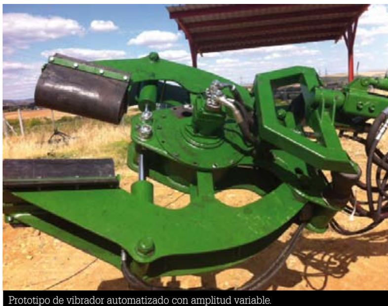
Prototipo de vibrador automatizado con amplitud variable.
