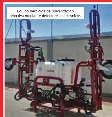
Equipo herbicida de pulverización selectiva mediante detectores electrónicos.
