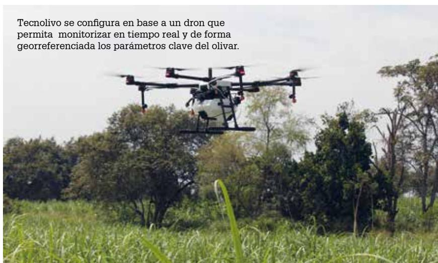
Tecnolivo se configura en base a un dron que permita monitorizar en tiempo real y de forma georreferenciada los parámetros clave del olivar.
