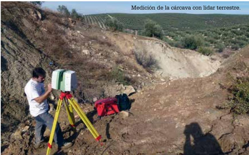
Medición de la cárcava con lidar terrestre.
