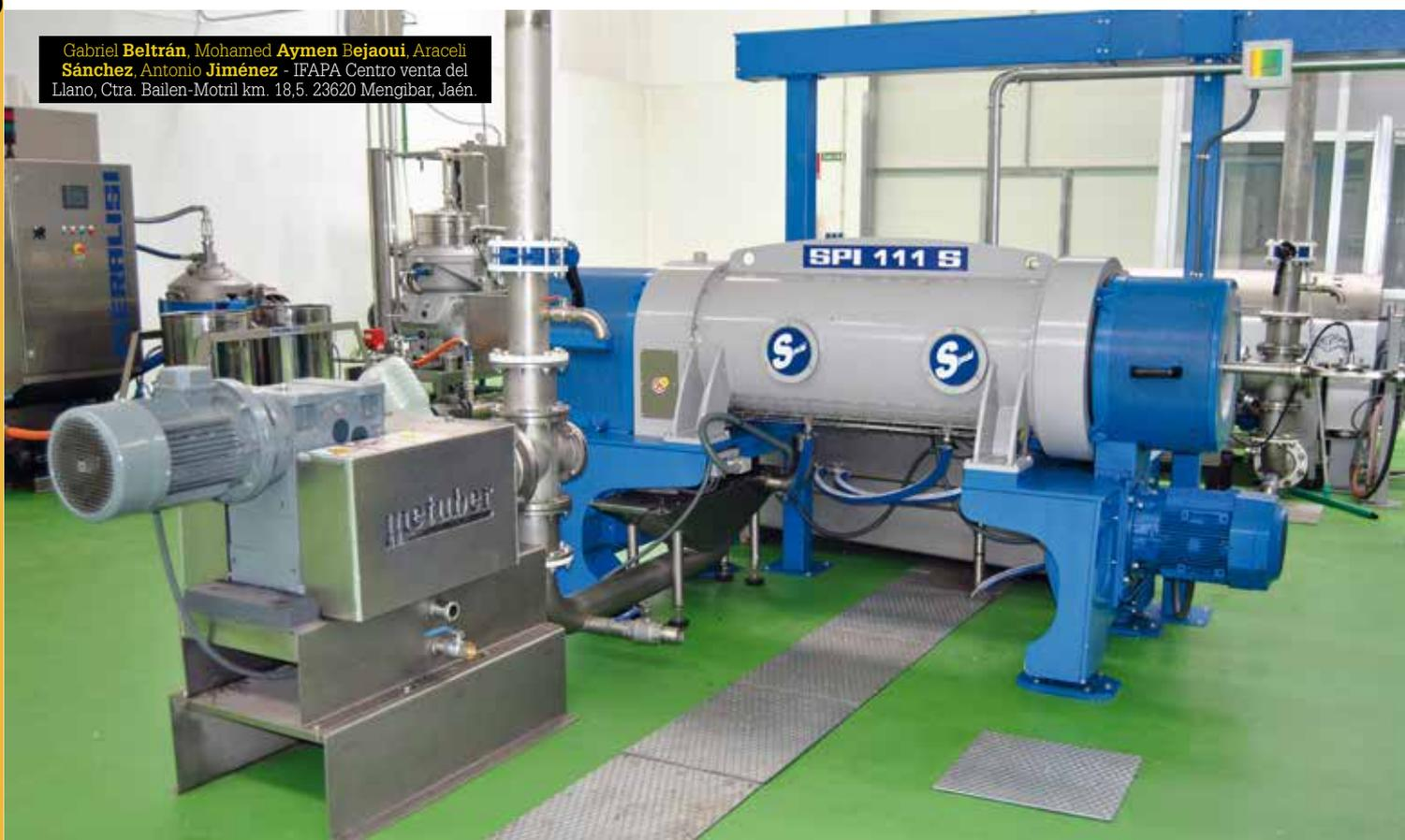
La molienda es una etapa fundamental a la hora de determinar el rendimiento del proceso de extracción del aceite de oliva ya que en ella se lleva a cabo la rotura de las estructuras celulares que permite la liberación del aceite, que en la etapa de batido se consiguen transformar en una fase oleosa continua.
