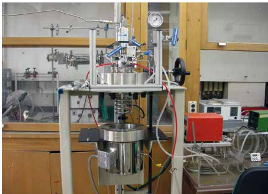
Figura 6.- Reactor de pretratamiento por agua caliente líquida.
