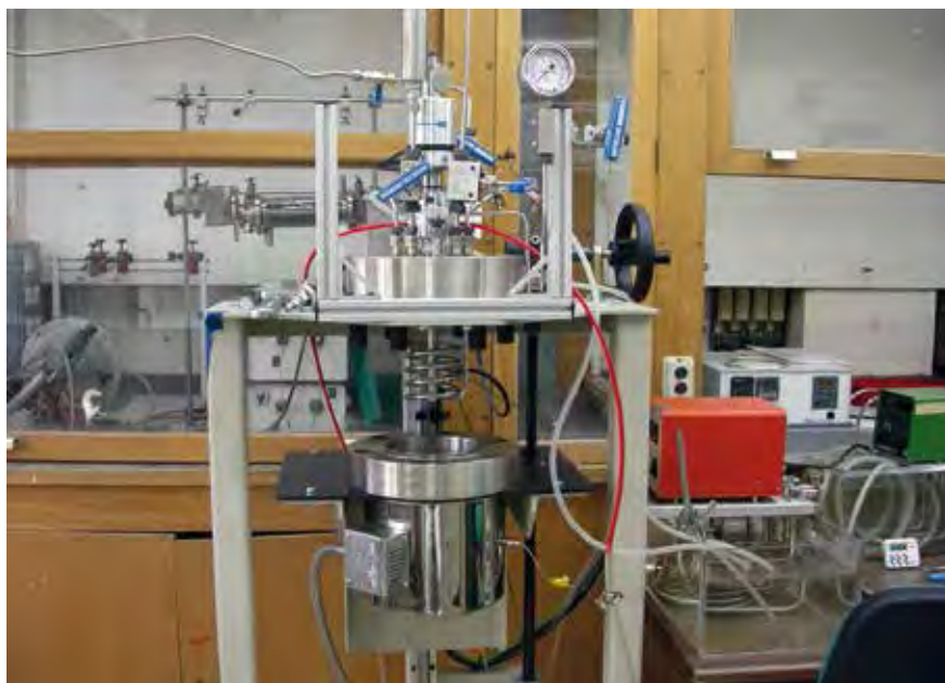
Figura 6.- Reactor de pretratamiento por agua caliente líquida.
