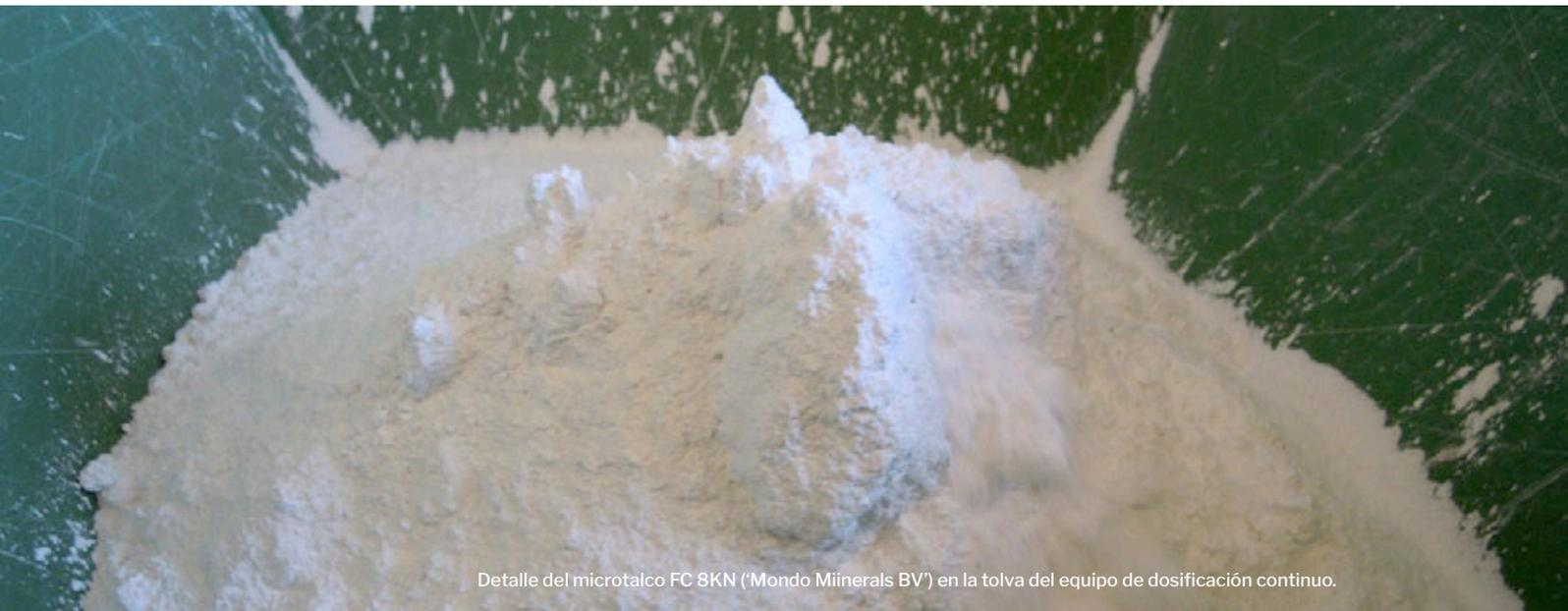
Detalle del microtalco FC 8KN ('Mondo Minerals BV') en la tolva del equipo de dosificación continuo.
