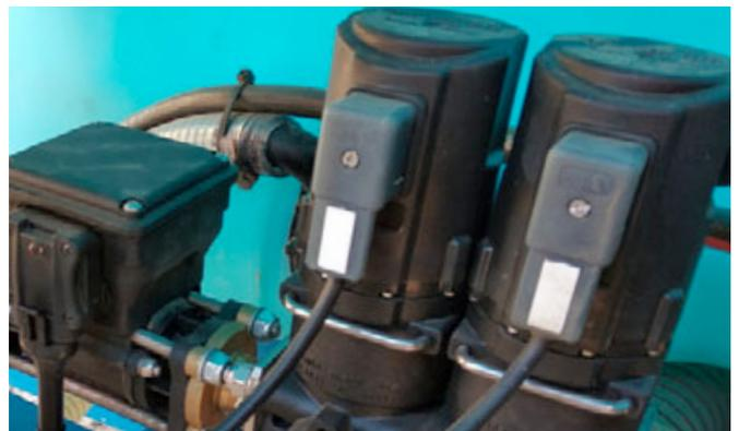
Kit de regulación del atomizador: Válvulas motorizadas y de control de presión y sensores de caudal y presión.
