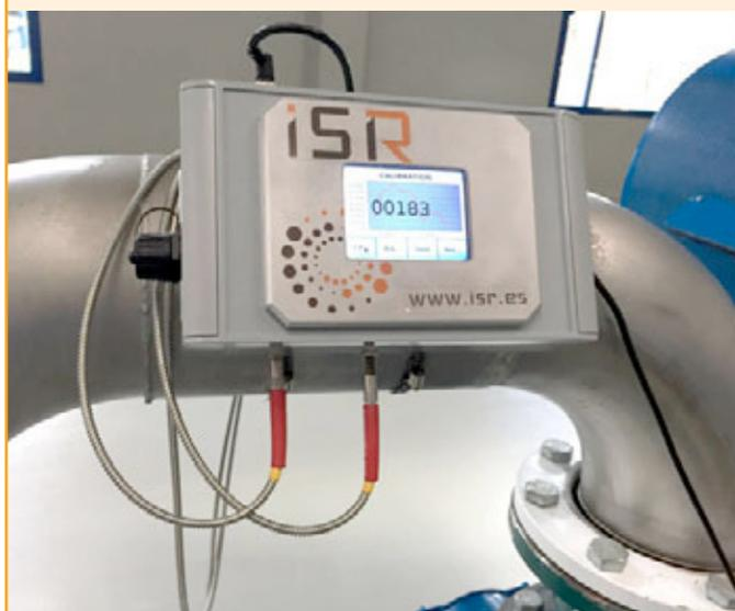
Dispositivo SMART-NIR instalado en la tubería de evacuación de orujos de un decánter.
