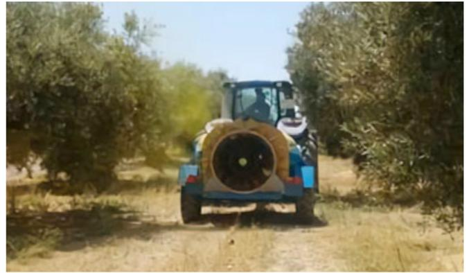
Ensayos para el ajuste del volumen específico de pulverización y de la influencia combinada del volumen de copa y la densidad foliar en tradicional e intensivo.
