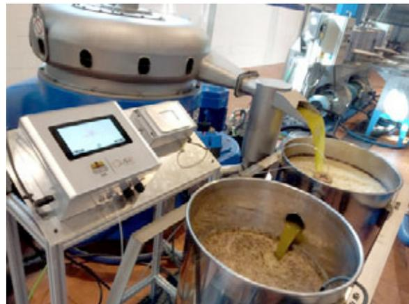
Sistemas SMART-ENOSE (izquierda) y SMART-NIR (derecha) instalados en la salida de aceite de una máquina centrífuga vertical.
