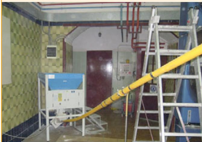
Equipo de dosificación continuo de microtalco al cuerpo de la batidora, indicando una de las posiciones de adición que fue ensayada.
