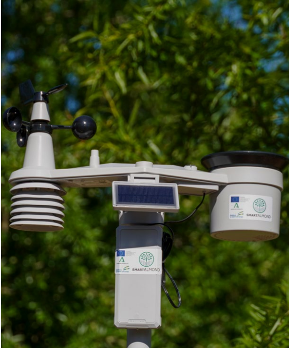
Estación meteo-smart de bajo coste utilizada en el proyecto SmartAlmond.
