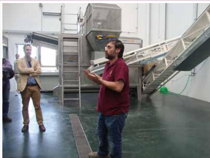
En la almazara Oliduero cabe destacar que todos los elementos que intervienen en el proceso de la entrada de aceituna a la factoría, están fabricados por la firma Sistemas de Fabricación SA, SAFI en acero inoxidable y las cintas transportadoras están fabricadas con banda blanca alimentaria. Importante resaltar el Sistema Compacto de limpieza, lavado y pesaje de la aceituna fabricado íntegramente en acero inoxidable y con una producción de 7/8.000 Kg / Hora.
