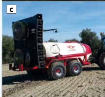
Figura 8. Prototipos de atomizadores adaptados a olivar tradicional e intensivo desarrollados dentro del Convenio "Mecaolivar": a) Prototipo con un ventilador centrífugo y difusores, b) Prototipo con seis ventiladores axiales laterales, c) Prototipo con doble ventilador axial montados en torre.
