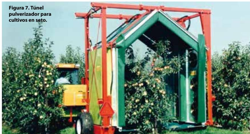
Figura 7. Túnel pulverizador para cultivos en seto.
