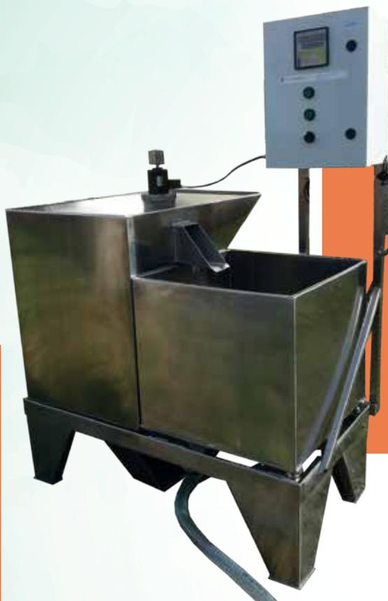
Decantador de pesadas continuas, en acero inoxidable, para el control de la producción y rendimiento del aceite.
