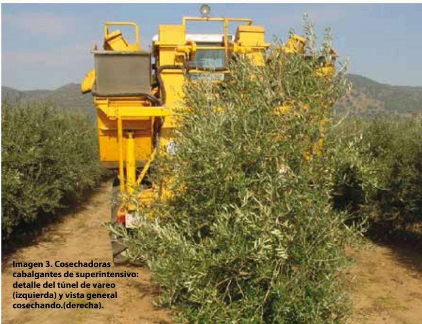
Imagen 3. Cosechadoras cabalgantes de superintensivo: detalle del túnel de vareo (izquierda) y vista general cosechando.(derecha).
